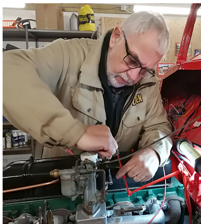
"Fiffer" i gang med at montere det nye og selv fabrikerede stangtræk til karburatoren på sprøjten. Situation fra den 16. november 2017
