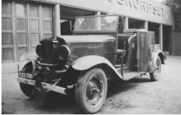
ZR's arbejdsvogn med gengas-generator.
