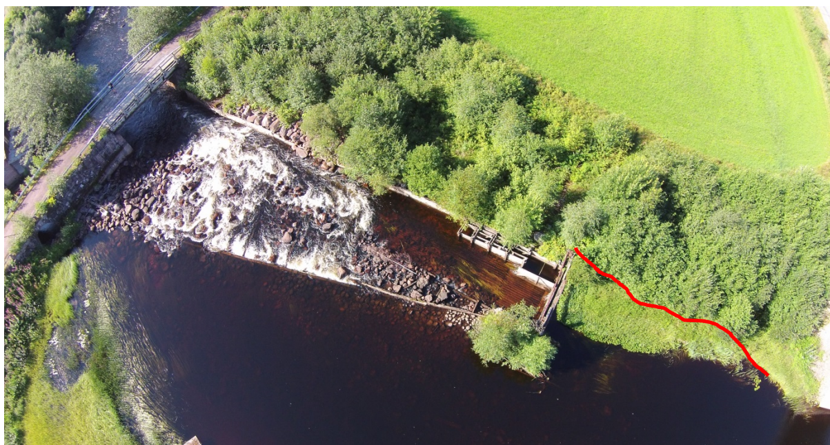
Figur 4. Flygfoto över dammläget. Det röda strecket visar var den nya strandlinjen uppströms dammutskovet anvisas.
