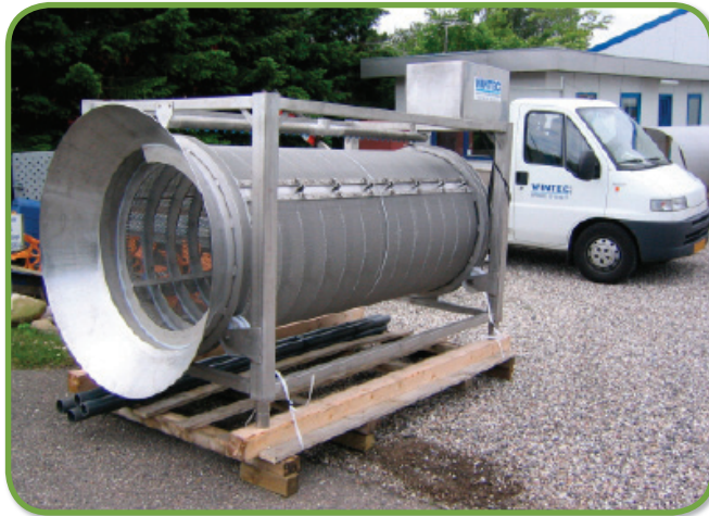
Tromlefilter med snegleudtræk
