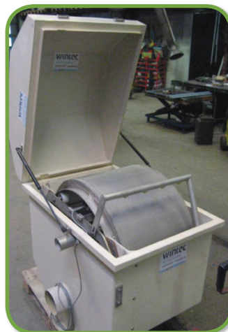
Nedgravet tromlefilter, som har erstatte bundfældningsbassin og overfaldskant
