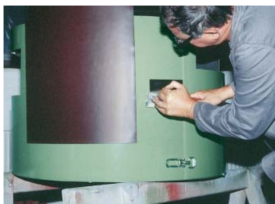
Zum Entdröhnen von Blechen erzielen bereits einfache Magnetfolien gute Ergebnisse.
