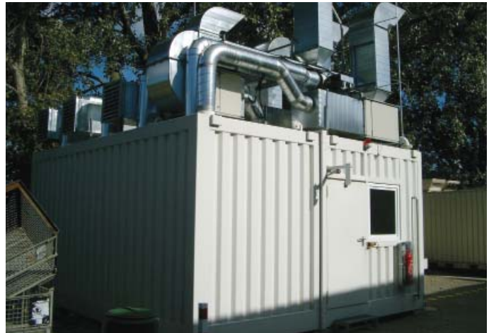
Schalltechnisch modifizierter Seecontainer als Dauerlauf-Prüfstand für Verbrennungsmotoren, Lieferung mit Be- und Entlüftung. Dämmung: 40 dB (A).
