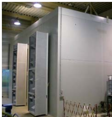
Schallschutzkapsel mit großen Flügeltüren.
