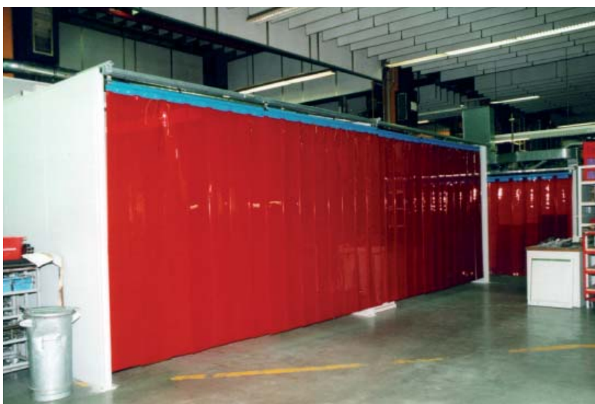
Kombinierte Schall- und Schweißerschutzkabine. Der vordere Vorhang ist an Laufschielen verschiebbar. Die Seiten und die Rückseite sind aus Schallschutzpaneelen und dienen zusätzlich der Schallabsorption beim Schleifen und Schweißen.
