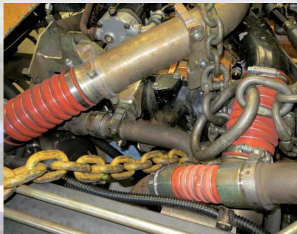
Turbo- og køleslanger med spændebånd på en MTU power pack
