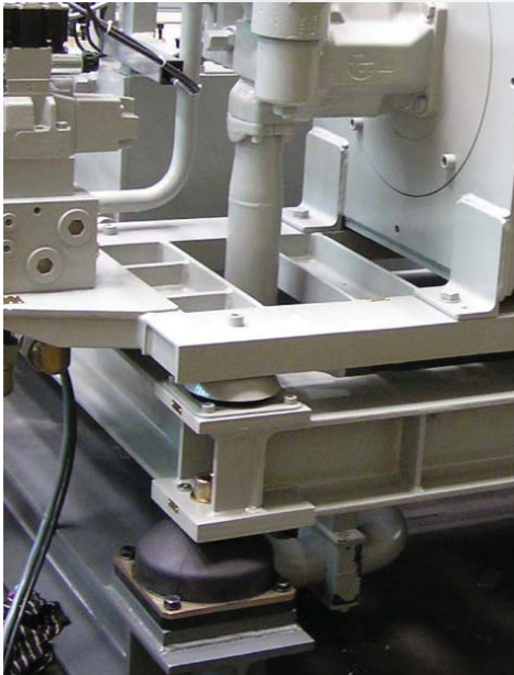
Dobbelt vibrationsophængning af maskine
