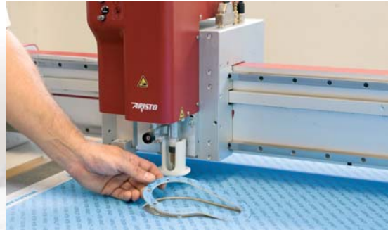
Planpakning skåret på plotter
