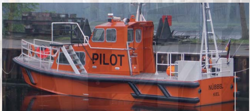
Specialfremstillet skumfyldt fenderliste med fiberforstærket PU-overflade
