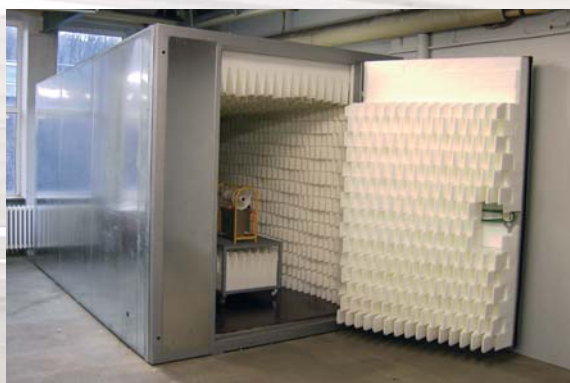
Lydisoleret testrum lavet med Contrabel paneler
