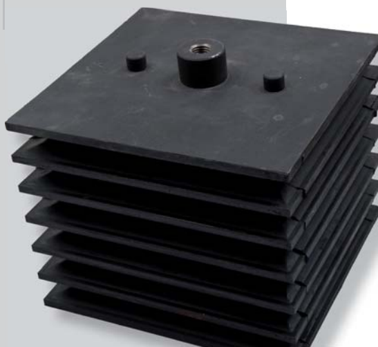
Vuggefjeder i sandwichkonstruktion til sekundæraffjedring
