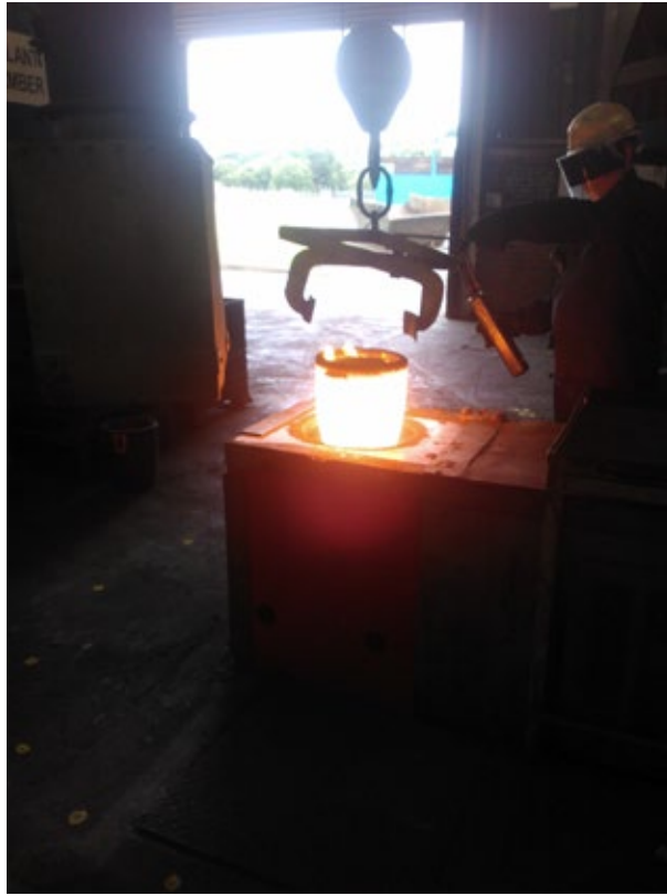
Figuur 8.5 — Taken die nabije toegang tot de oven omvatten worden uitgevoerd als de oven is uitgeschakeld
