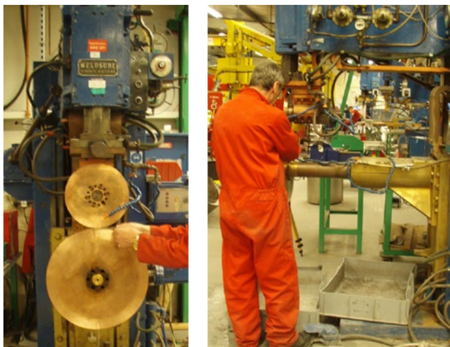
Figuur 7.3 — Voor- en zijkant van naadlasmachine
