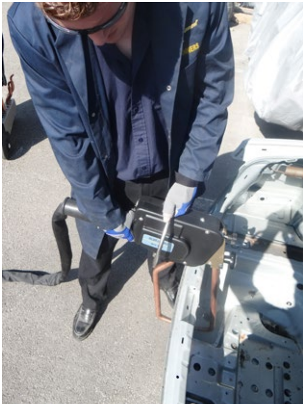
Figuur 6.1 — Een draagbare puntlasmachine die wordt gebruikt om een nieuw paneel te bevestigen
