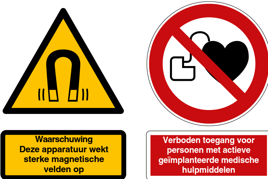
Figuur 4.12 — Voorbeelden van waarschuwingsmeldingen voor sterke magnetische velden en een weergave van het verbodssymbool voor personen met AIMD
