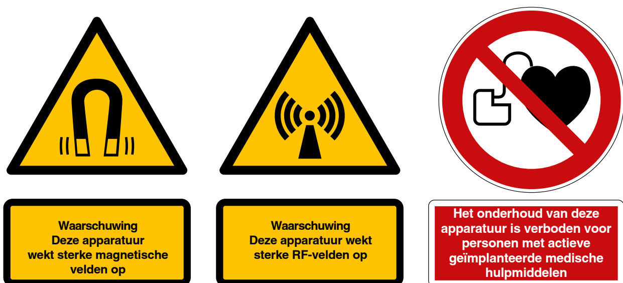
Figuur 9.5 — Voorbeelden van waarschuwingsmeldingen voor sterke magnetische en sterke RF-velden en een weergave van het verbodssymbool voor personen met AIMD
