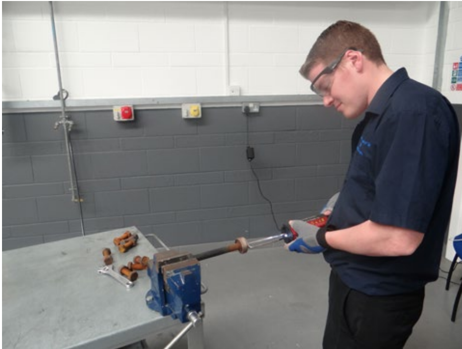
Figuur 6.3 — Een draagbaar inductieverhittingssysteem van 1 kW wordt gebruikt om een vastgelopen bout te verhitten
