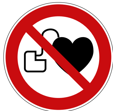
Figuur 7.10 — Voorbeelden van waarschuwingsmeldingen voor sterke magnetische velden en een weergave van het verbodssymbool voor personen met AIMD
