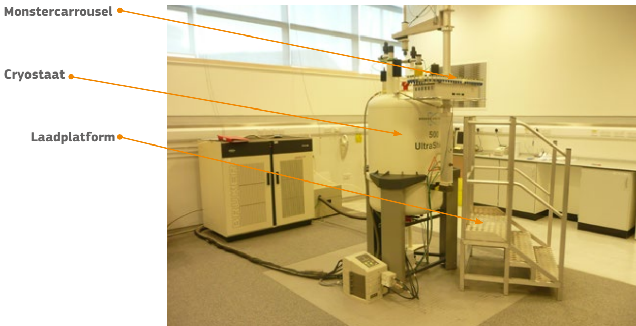
Figuur 2.1 — NMR-eenheid, volledig met monstercarrousel en laadplatform
