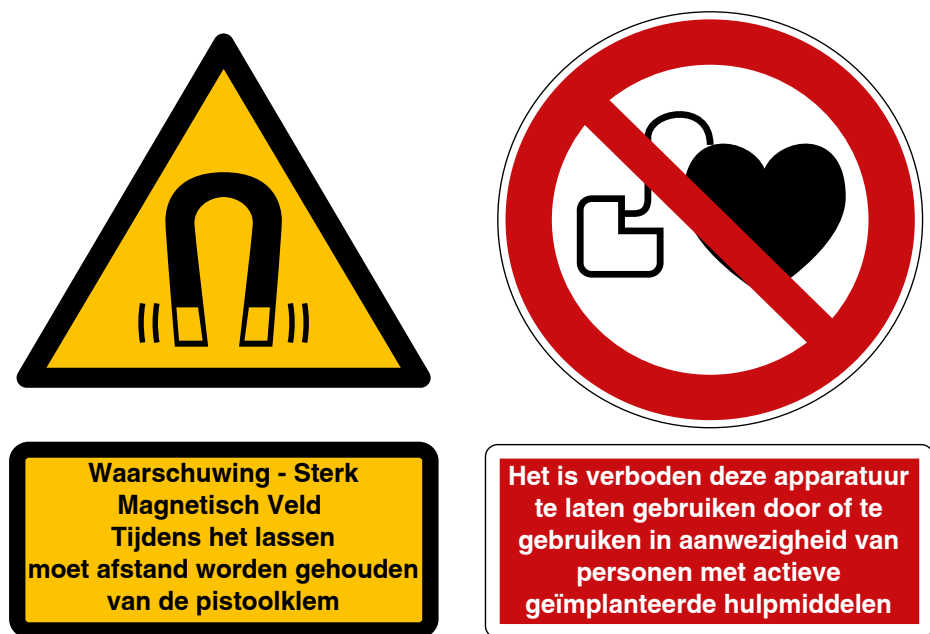
Figuur 6.15 — Voorbeelden van een melding die waarschuwt voor sterke magnetische velden en een melding die het gebruik van de lasmachine verbiedt voor of in de aanwezigheid van personen met AIMD
