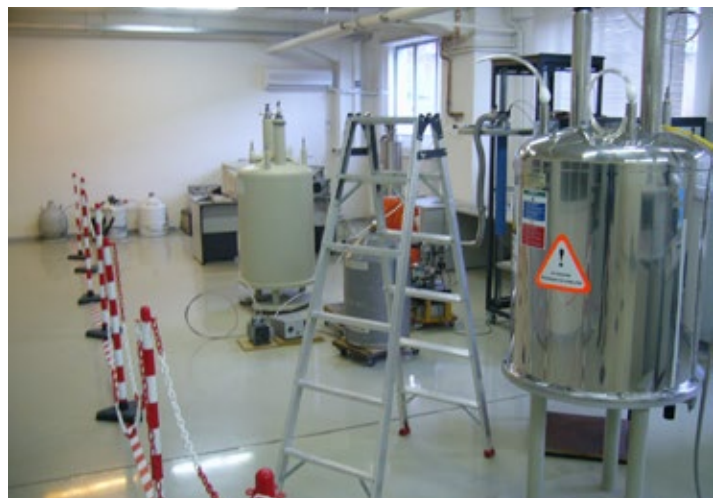
Figuur 2.4 — Afbakening van het verboden gebied door een barrière met kettingschakels en markering van de vloer
