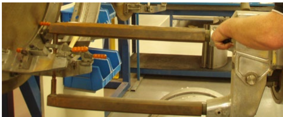
Figuur 7.2 — Draagbare hangende puntlasmachine
