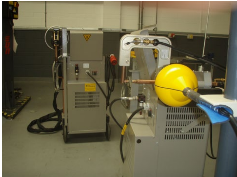
Figuur 6.7 — Metingen rond de puntlasmachine van het carrosseriebedrijf, uitgerust met een „C-type”-pistool en de arm van 160 mm geïnstalleerd. De puntlasmachine met „X-type”-pistool bevindt zich op de achtergrond
