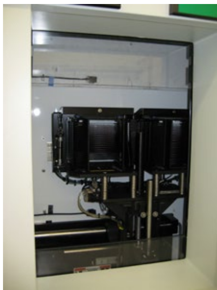
Figuur 9.1 — Zone voor plaatsing van wafers
