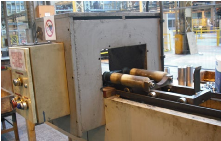
Figuur 5.2 — Demagnetisator met glijdende trolley
