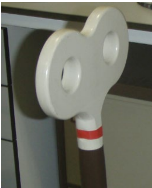
Figuur 4.2 — TMS-spoel in de vorm van een acht
