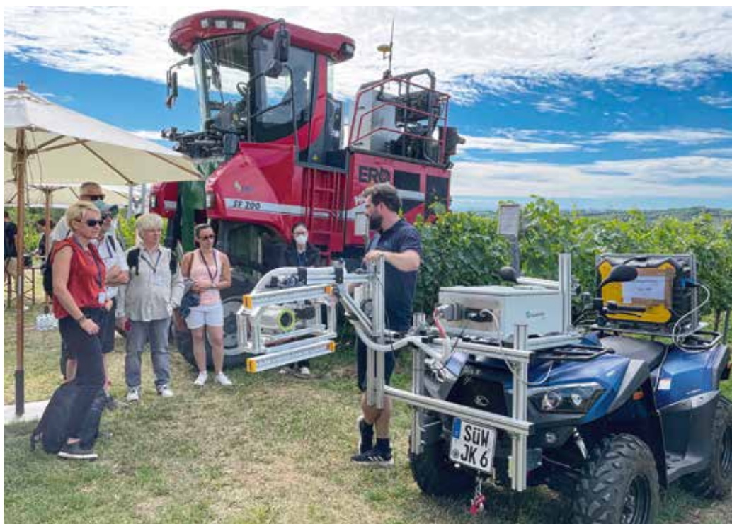
Foto 4. JKI forsker præsenterer de 2 mobile platforme med monterede kameraer og andet udstyr på ATV og en ombygget portalhøster.
