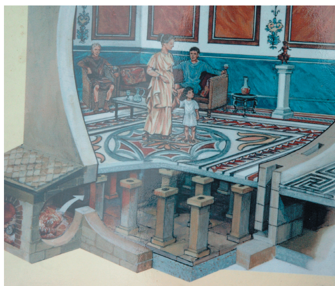
Moderne tegning: Dagligstue med gulvmosaik. Varmeanlæg under gulvet. Til venstre i billedet ses kedelrum, praefurnium (nr. 26).
