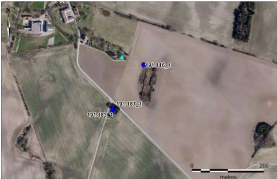
FIGUR 7.9. VANDVÆRKETS INDVINDINGSBORINGER OG VANDVÆRK.
