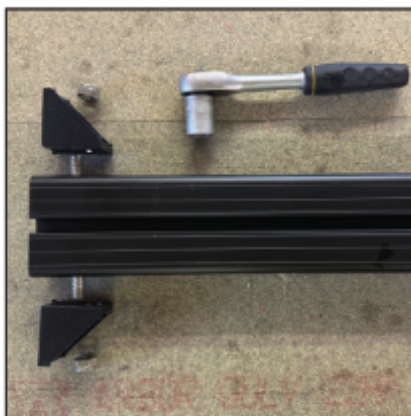
Monter festebrakettene med mutter og skrue, strammes med 13mm skralle.
