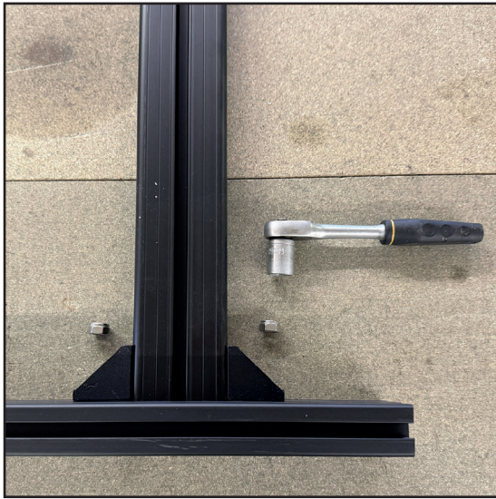
Fest sperrene til rammen med mutter.
