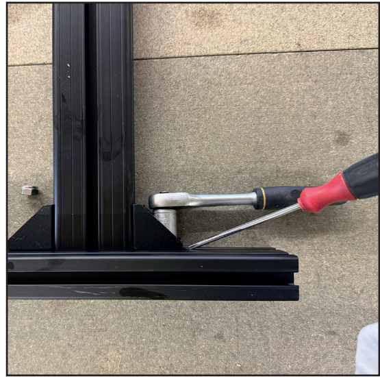
Lås bolten med skrutrekker.
