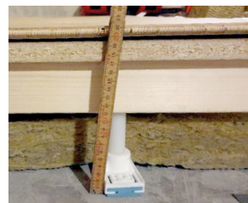
M9/M21. Referensbjälklag betong, Ljudfot 12,5 mm med 150 mm plastskruv, golvspån 22 mm, Aerolen, parkett.
