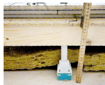
M3. KL-Trä, Ljudfot 25 mm med 150 mm plastskruv, golvspån 22 mm, 2 x golvgips, Aerolen, parkett.
