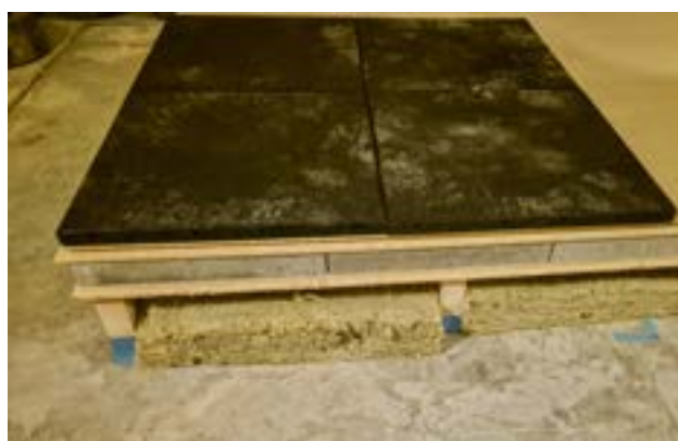
Eltecpur 30 mm på skivkonstruktion med betongplattor och 50 mm Vibradyneplattor.
