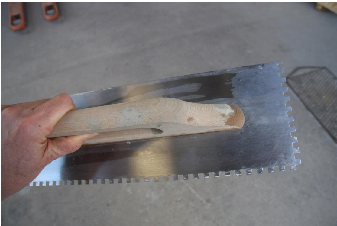
Bild 3 – Spackelspaden för "klinkerfixet", tandning: 6 x 6 mm.
