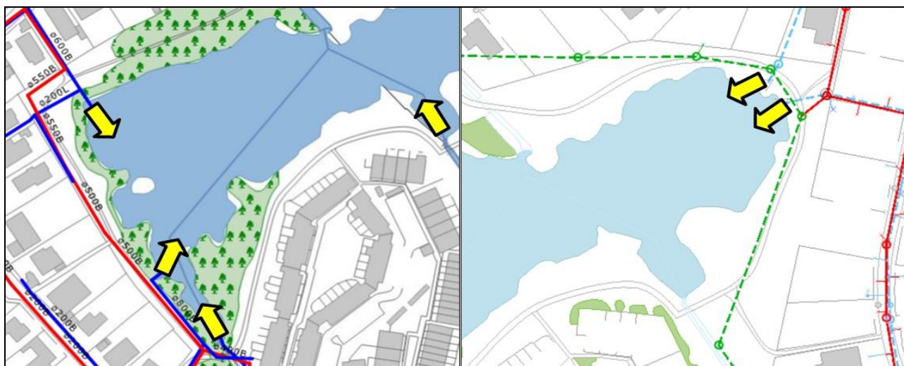
Figur 4. Lednings-kort fra Hofor og Novafos. Blå ledninger er regnvand fra tage og veje, rød er spildevand og grøn er blandet regn- og spildevand. Kun blå ledninger (regnvand fra tage og veje) leder til Vesterled Sø.
