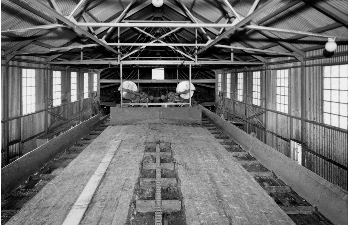
Kappeanlegget. Tømmeret kom inn i midten, på transportøren fra kjerraten. Stokkene ble veltet til side, inn på linjene til kappsagene i bakgrunnen. Tømmeret ble kappet til kubb som falt med på transportører som tok det videre til fordelingssentralen. Bilde: N. W. Knutsen
