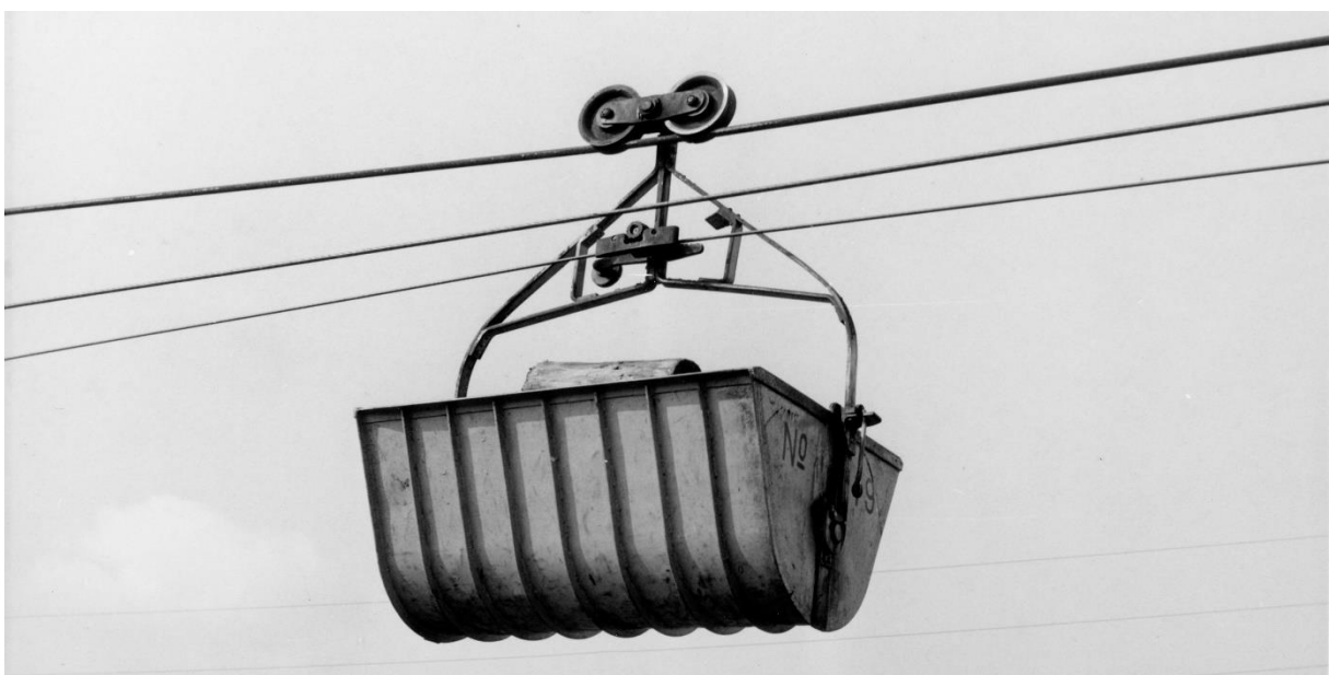
Toten Cellulosefabrikk produserte vaggene til taubanen på sitt eget mekaniske verksted. Løpehjulene hviler på bærekabelen, og en klemanordning fester vaggene til trekk-kabelen. Klemanordningen ble utløst når vaggene kom til vendestasjonene eller passerte strammestasjonen. Løpehjulene ble ledet inn på en skinne. Bilde: N. W. Knutsen
