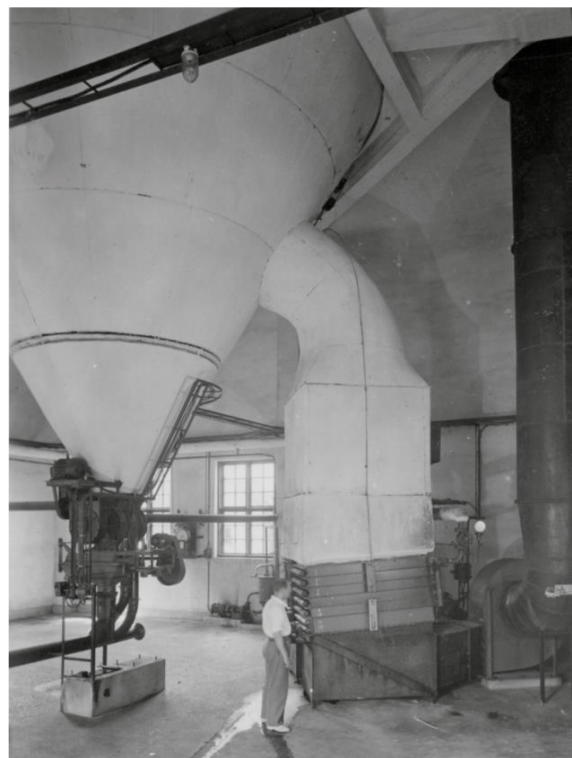
Nedre del av syklontørke for Totanin-pulver i Niro-avdelingen
