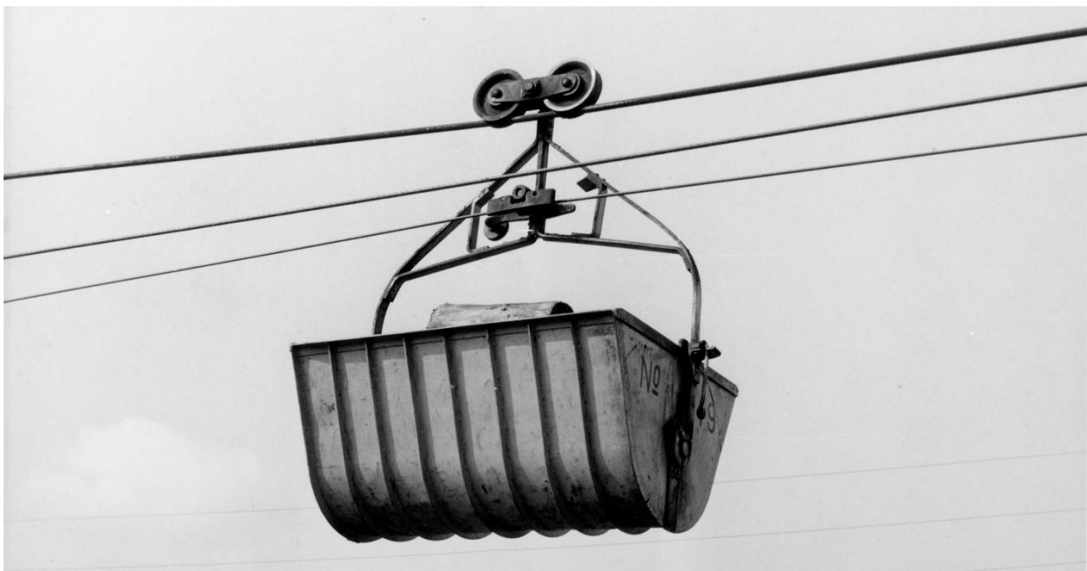
Toten Cellulosefabrikk produserte vaggene til taubanen på sitt eget mekaniske verksted. Løpehjulene hviler på bærekabelen og en klemanordning fester vaggene til trekk-kabelen. Klemanordningen ble utløst når vaggene kom til vendestasjonene eller passerte strammestasjonen og løpehjulene gikk på en skinne. Bilde: N. W. Knutsen
