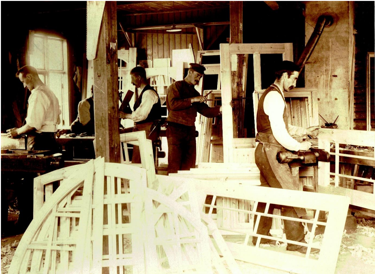
Produksjon av vinduer for Gjøvik stasjon ca. 1900. Petter Olsens sønn Ole er nr. 2 fra venstre. Bilde: Mjøsmuseet
