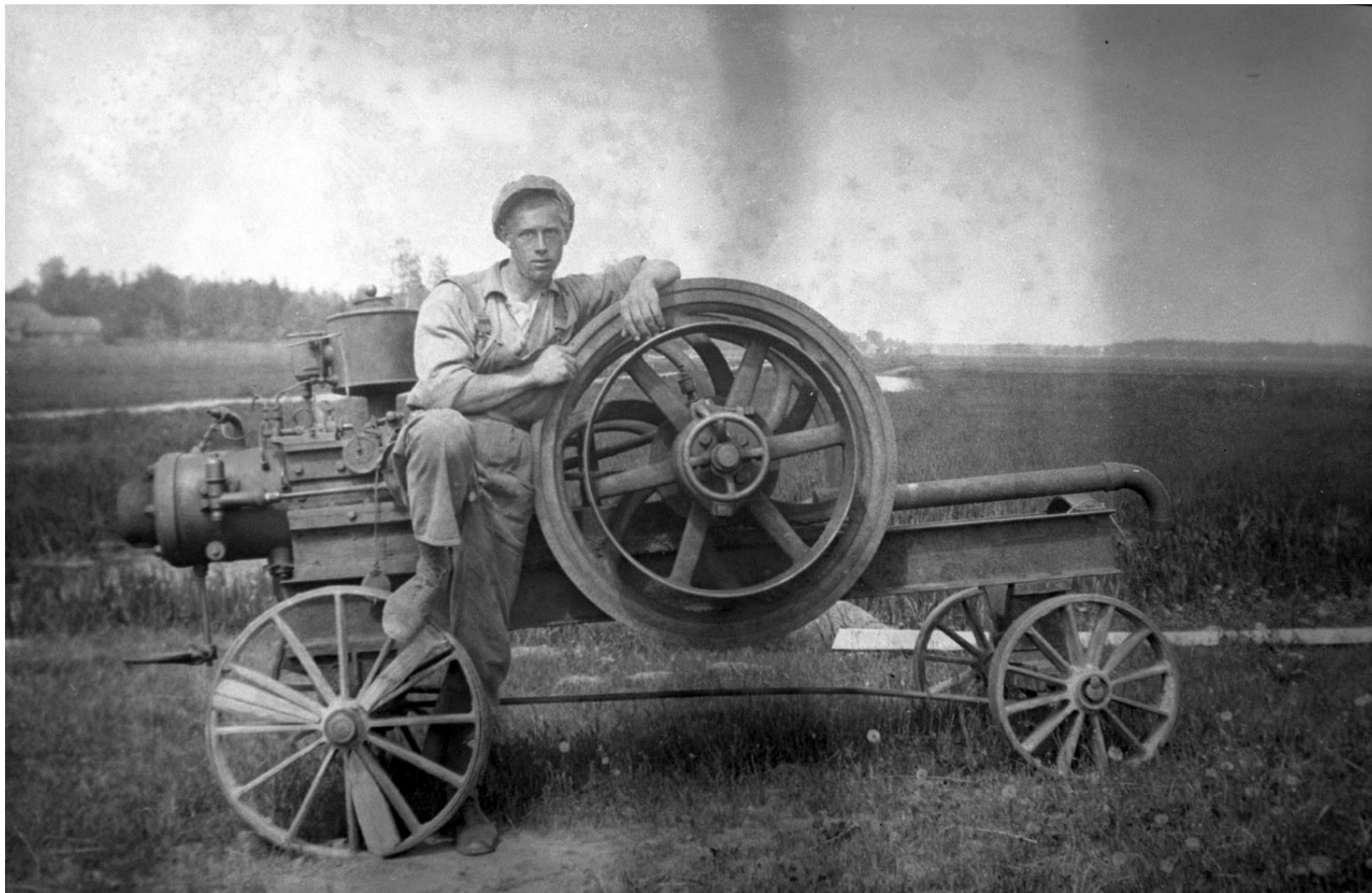
Karl Johansson, Trombäljen nr 5, Skära, håller i vänster balanshjul till en råoljemotor. Foto från Hästefjord nr 1.
