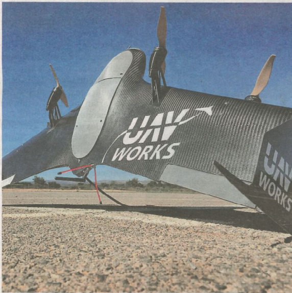
El vehículo de UAV Works despega de manera vertical.
