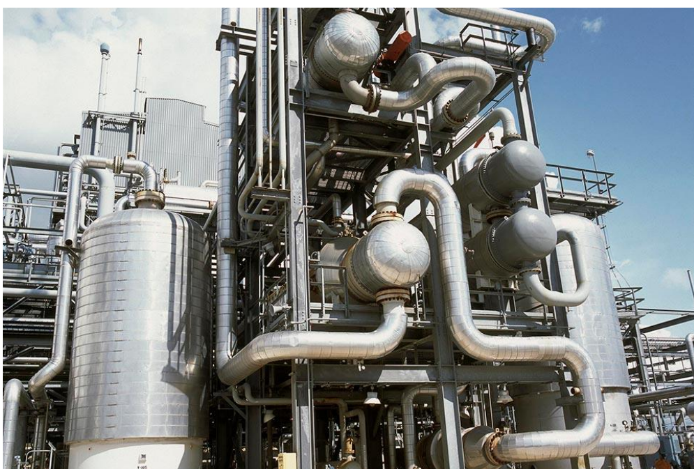
Steam Reforming anlæg til grå eller blå brint produktion ved Air Products and Chemicals Inc., USA.
