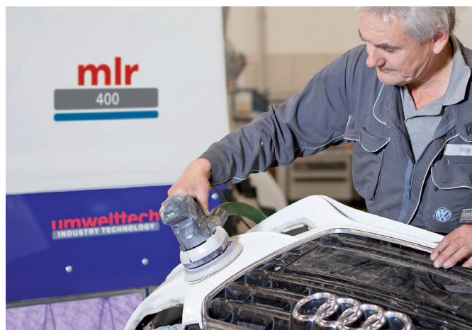
Der mobile Luftreiniger ist für das Abscheiden von Stäuben und Gerüchen konzipiert.
