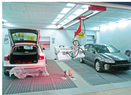
Vorbereitungsplätze mit Infrarotstrahler
