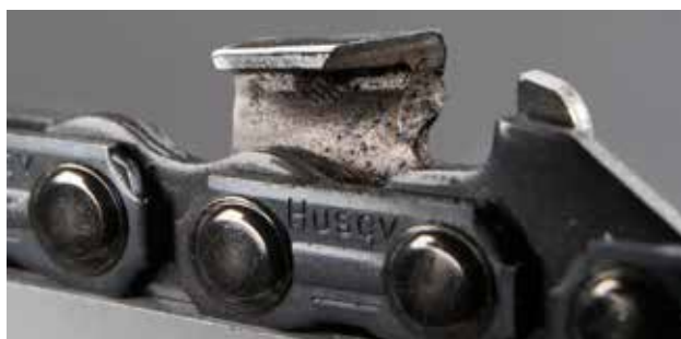
Här kan du se hur det ser ut när en skärtand är "träslö". Då är det är bög tid att skärpa skärtänderna. Lägg märke till skärtandens "vita" egg.
