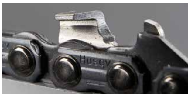
Bakåtlutande vinkel. Skärtanden är filad för högt upp, vilket gör att den skär dåligt. Använd filmall och fila om skärtänderna efter rekommendation.
