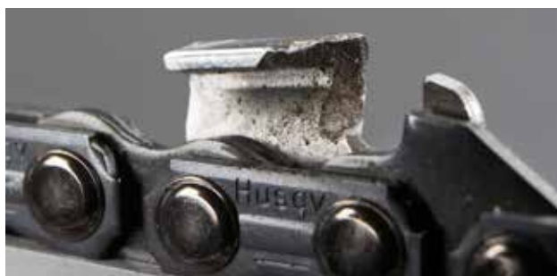
Den stensägade skärtanden visar upp en oregelbunden egg där det översta skiktet av skärtanden är skadat. Det är viktigt att hela skadan filas bort för att få en bra skärpa.
