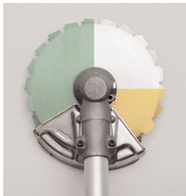
Klingan har olika egenskaper beroende på vilken del av den som används. Sektorn mellan klockan 8 och 12 ger full kontroll och bra precision. Sektorn mellan klockan 3 och 5 ger snabb genomsågning men något sämre precision.
