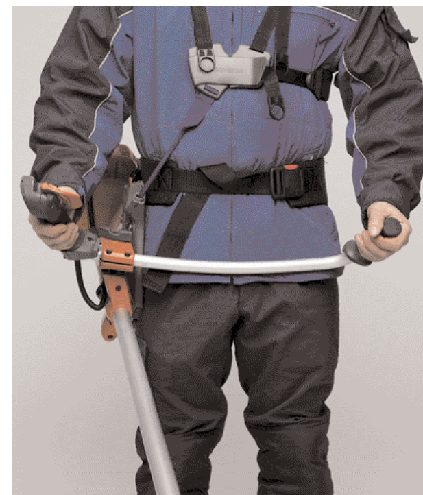
3. Styre i sidled. Justera styret så att handtagen sitter rakt framför armarna.
