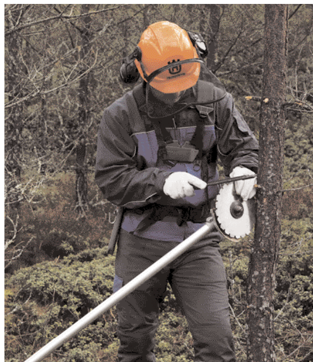
Lutad mot träd. Stöd klingan mot stammen i höfthöjd. När du filat klart i en riktning går du runt till andra sidan och tar resten.
