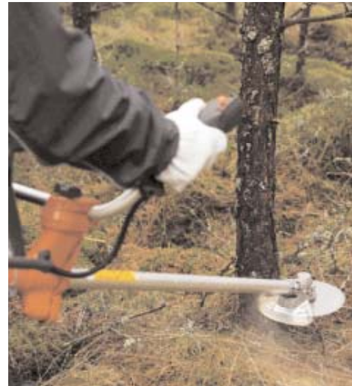
Stammar med en diameter på 8–15 cm måste sågas med två snitt, ett från varje sida.
