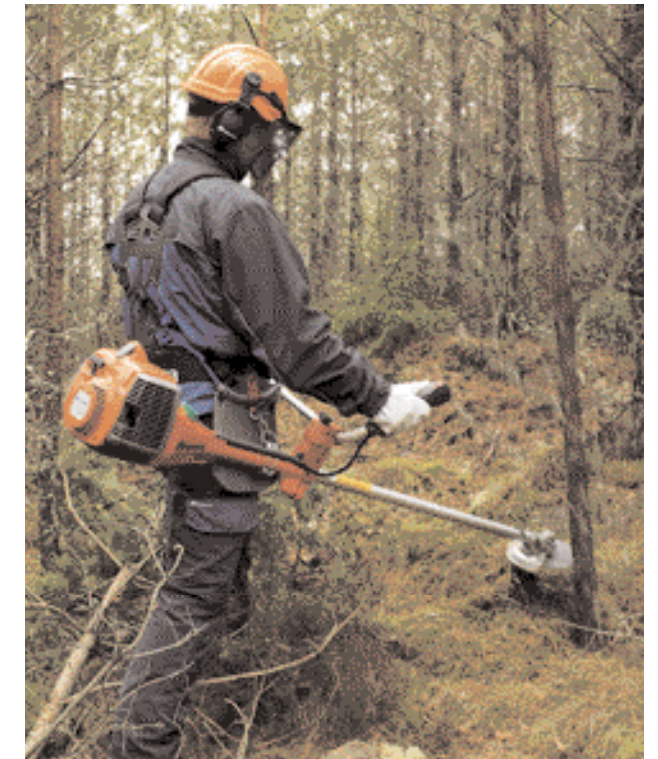
När stammarna är mellan 3–8 cm kan du enkelt bestämma åt vilket håll stammarna faller.
