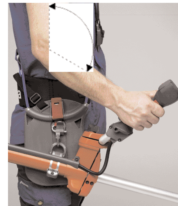
4. Vinkel på handtag. Justera handtagen så att handleden är rak och vinkeln i armbågen är ca 120°.
