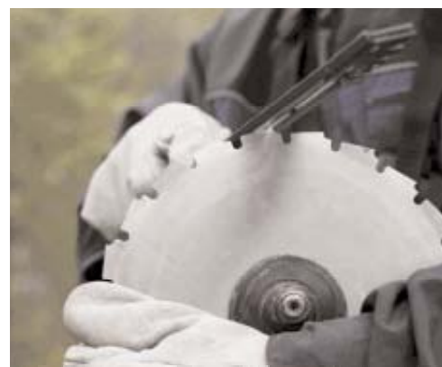
Se till att du har bra stöd när du filar. Bäst resultat får du om du fixerar klingan i ett skruvstycke, men du kan också fila medan du håller maskinen och klingan i ett stadigt grepp.
