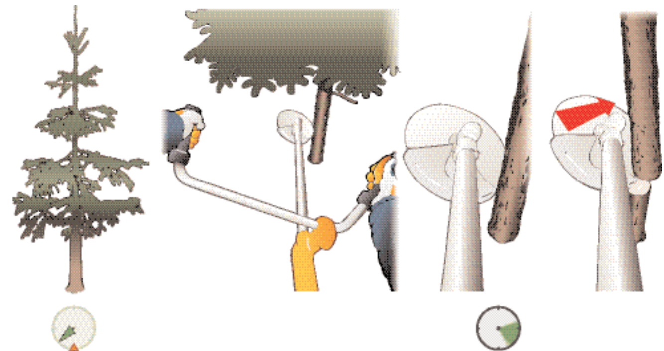
Fällning åt vänster, snett bakåt. Vinkla klingan åt höger. Sätt an klingan klockan 4. Såga igenom och skjut på åt höger.
