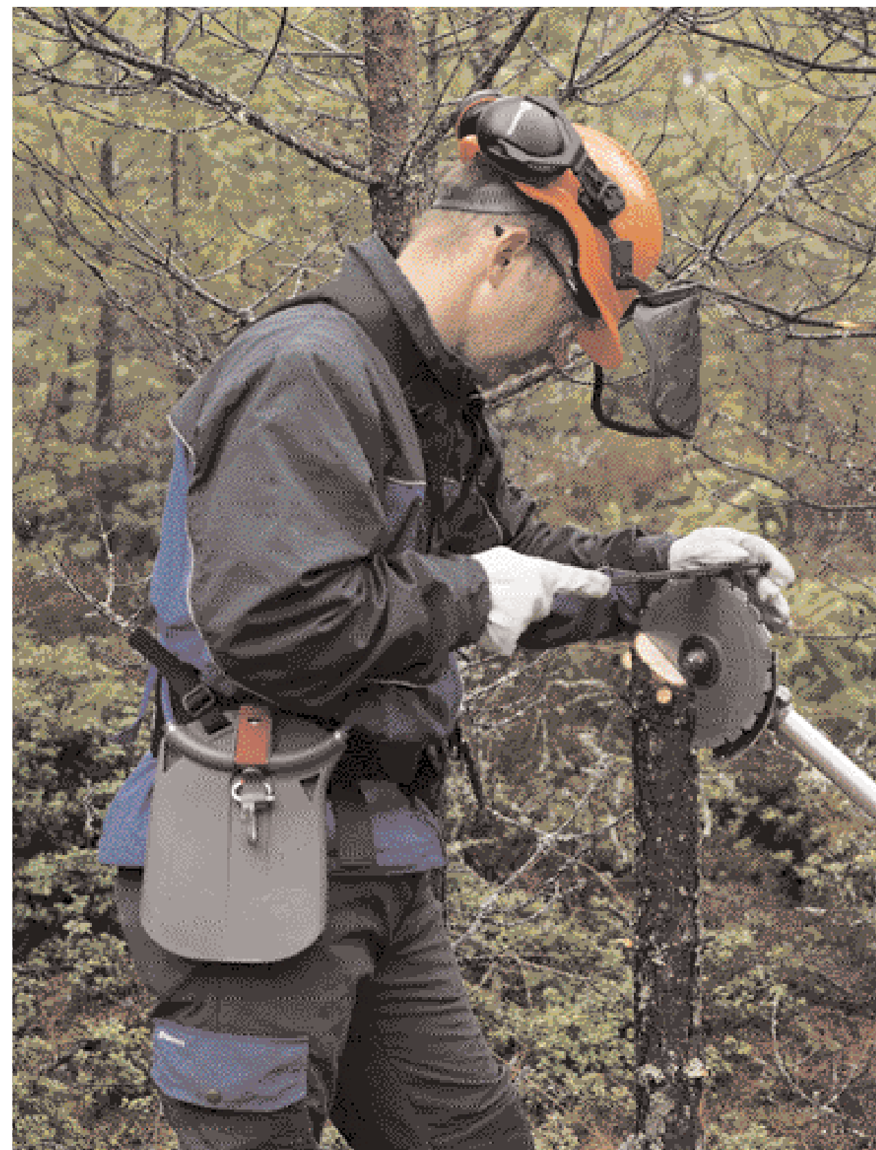
Filstubbe. Störst precision i filningen får du om du gör en filstubbe.
