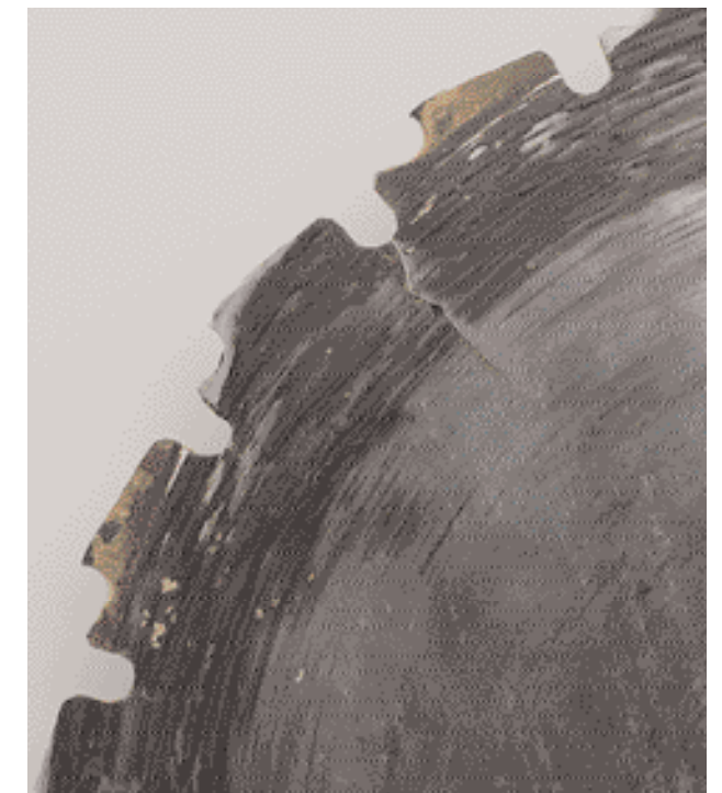
Var uppmärksam på sprickbildningar i klingan. Upptäcker du sprickor måste du genast byta klinga.
