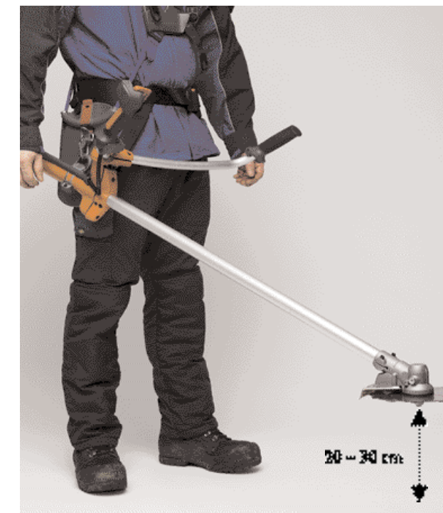
2. Höjd över marken. Se till att sågklingan balanserar 20–30 cm över marken.
