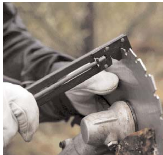
Klingan behöver skrännas regelbundet. Ju hårdare träslag du sågar i, desto oftare behöver du skränka klingan.
