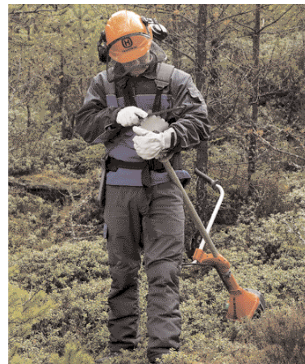
Stående. Vila klingan mot kroppen och håll fast den med ena handen. Fila en tand och rotera sedan fram till nästa. När ena sidan är klar, roterar du sågen ett halvt varv och filar andra sidans tänder.
