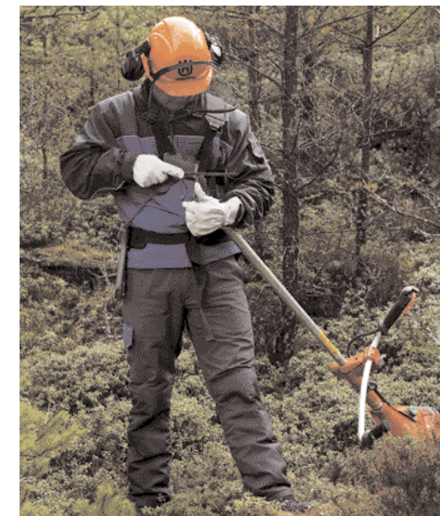
Stående. Vila klingan mot kroppen och håll fast den med ena handen. Fila en tand och rotera sedan fram till nästa. När ena sidan är klar, roterar du sågen ett halvt varv och filar andra sidans tänder.
