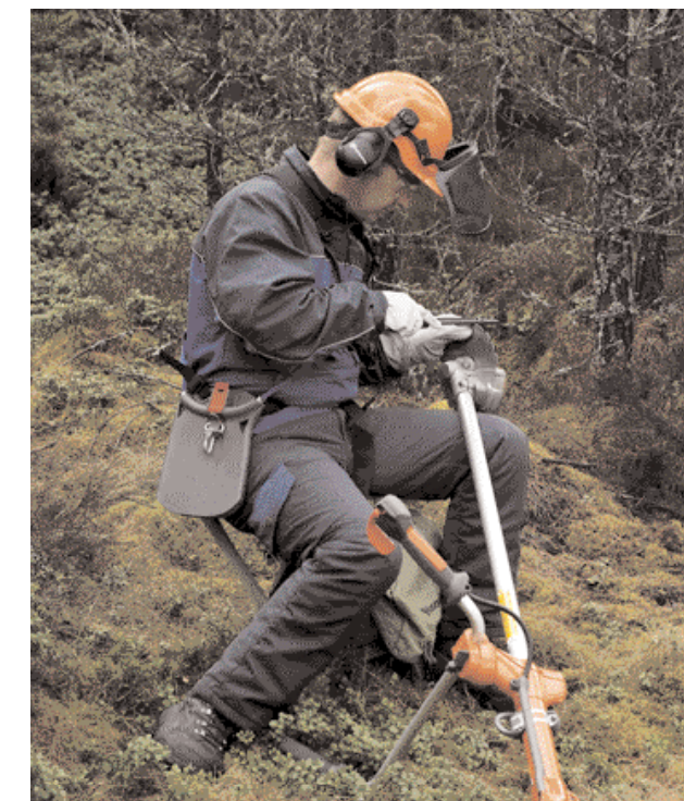
Sittande. Vila riggröret på benet. Håll fast klingan med ena handen. Fila alla tänder i en riktning. Vänd sedan sågen och fila andra sidans tänder.
