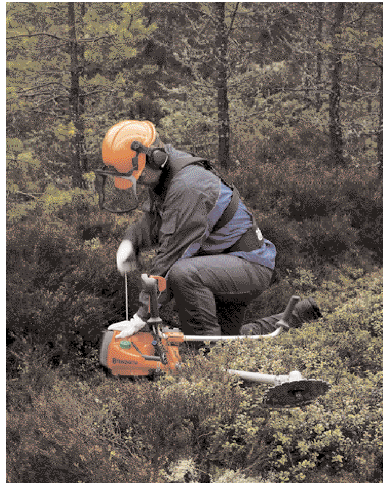
Vid start placerar du skogsröjsågen på marken mot ett fast underlag och ser till att klingan kan rotera fritt. Tryck maskinen mot marken och dra långsamt i starthandtaget tills du känner ett motstånd. Fortsätt med ett distinkt, snabbt drag.
