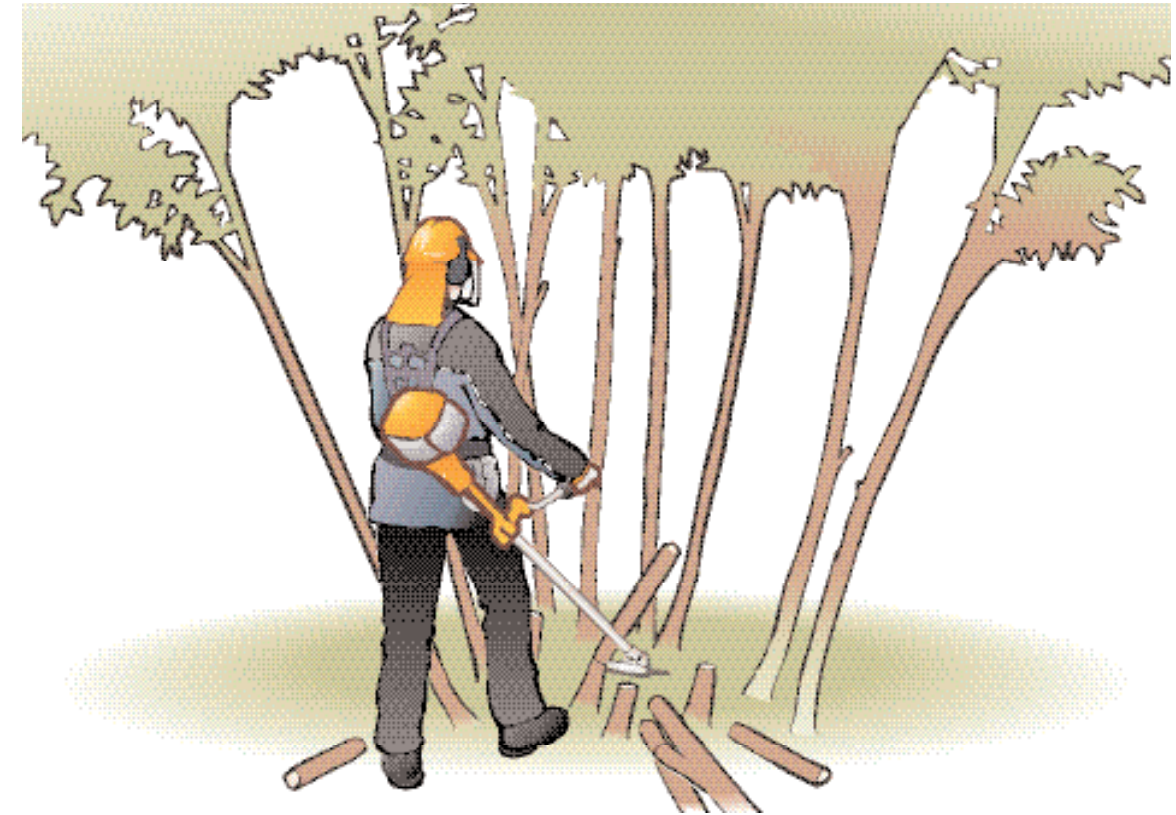
Försök att komma in med klingan och såga från buketten centrum.
