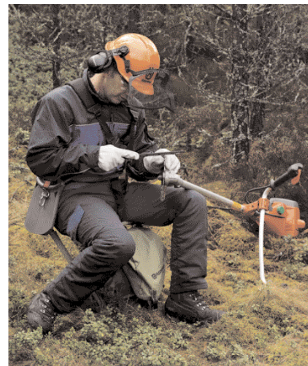
Sittande. Vila riggröret på benet. Håll fast klingan med ena handen. Fila alla tänder i en riktning. Vänd sedan sågen och fila andra sidans tänder.
