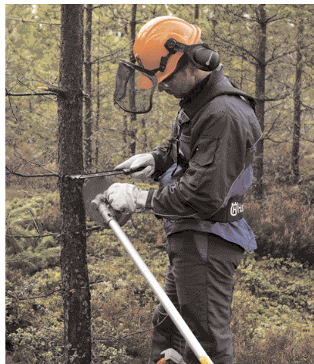
Lutad mot träd. Stöd klingan mot stammen i höfthöjd. När du filat klart i en riktning går du runt till andra sidan och tar resten.
