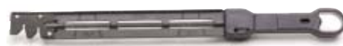
Den utrustning du behöver vid filning av klingan är en 5,5 mm rundfil och en filmall.
