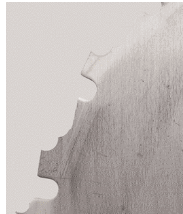
När du filat tanden så att enbart ca 5 mm återstår är det dags att byta klinga.
