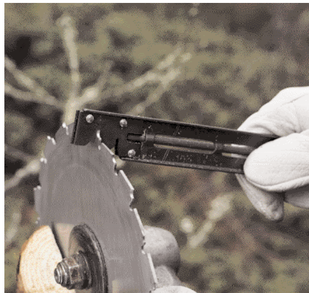
Skränkning av klingan ska göras för att behålla en god skärkapacitet och undvika att klingan klämmer i sågspåret.
