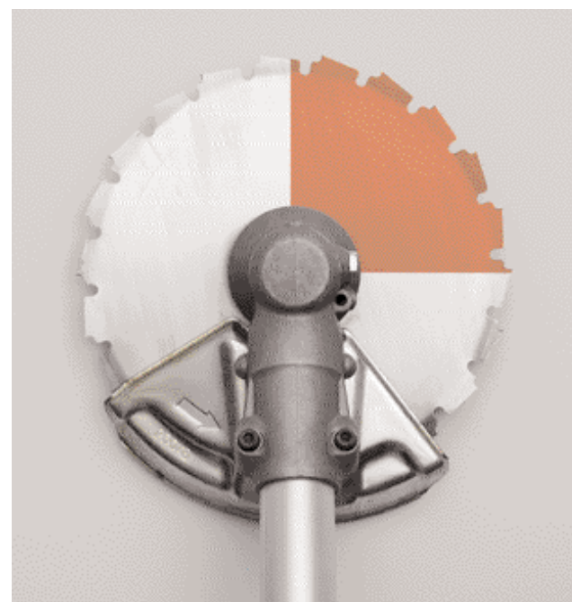
Sektorn mellan klockan 12 och 3 på klingan är en kastriskzon vid fällningar av stammar grövre är 3 cm i diameter.
