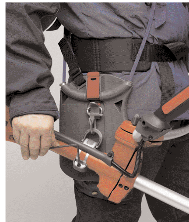
1. Upphängningsöglan. Fixera öglan i en position så att styret blir vågrätt när sågen hänger fritt.
