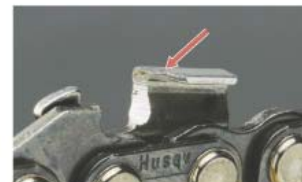
Den stensågade skärtanden visar upp en oregelbunden egg där det översta skiktet av skärtanden är skadat.
