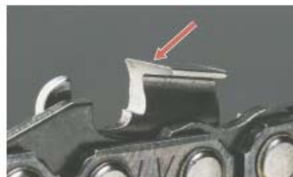
Här kan du se hur det ser ut när en skärtand är "träslö". Då är det hög tid att skärpa skärtänderna. Lägg märke till skärtandens "vita" egg.
