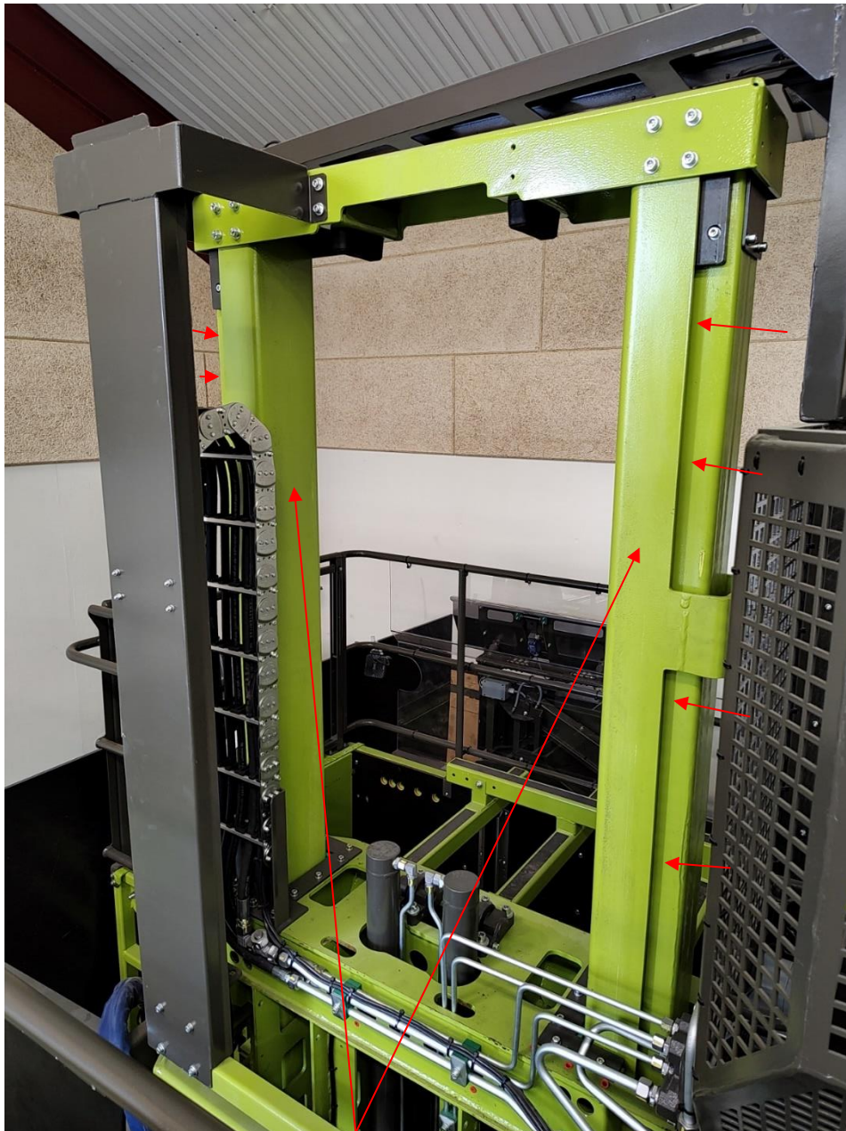
Lubrification des profils de la tour.
