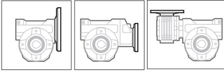
Le tabelle per la selezione riduttori possono essere utilizzate anche per i riduttori nella configurazione P (predisposti per attacco motore IEC B5 o B14).
