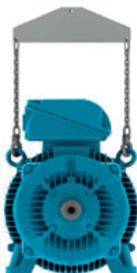
Bild 4.6 - Einsatz eines Querbalkens zum Heben
