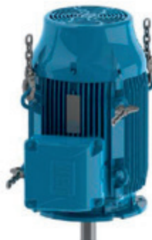
Figura 4.17 - Instalação do segundo par de olhais
