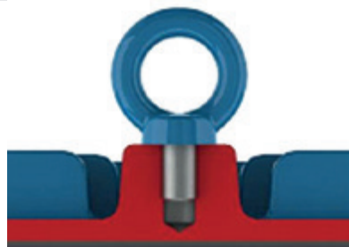
Фигура 4-1 – Правилно затягане на болта с халка
