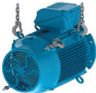
Фигура 4-10 – Монтаж на втора двойка болтове с уши
