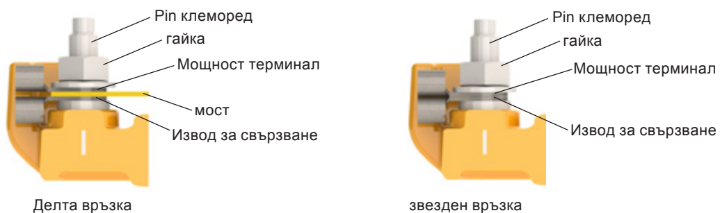
Фигура 6-13 - Свързване на двигатели W21 и W22 с клеморед
