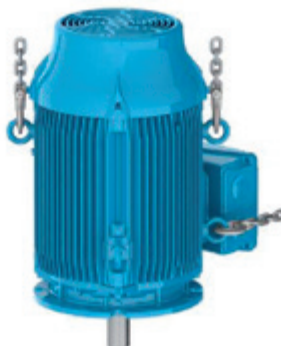
Рисунок 4.11 - Конечный результат: электродвигатель расположен вертикально
