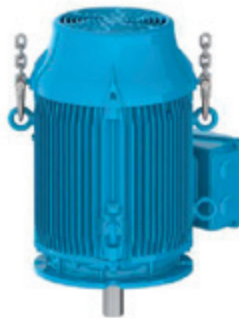
Bild 4.16 - Einbau des ersten Paares Transportösen
