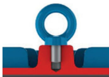
Рисунок 4.1 - Правильное затягивание рым-болта
