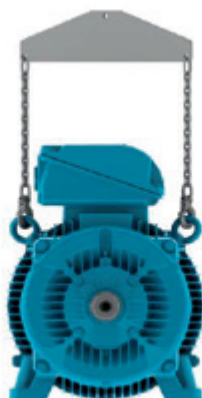
Figura 4.6 - Uso de barra separadora no içamento
