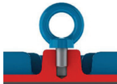
Bild 4.2 - Falsche Befestigung der Transportösen
