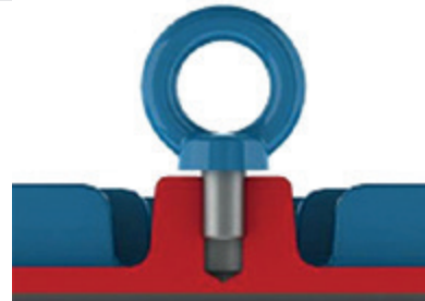
Фигура 4-2 – Неправилно затягане на болта с халка
