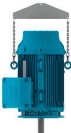
Bild 4.7 - Handhabung von vertikal aufgestellten Motoren
