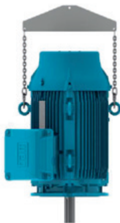
Рисунок 4.7 - Подъем электродвигателей вертикальной установки
