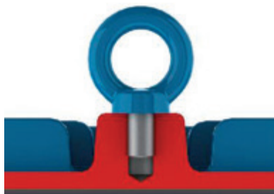
Bild 4.1 - Richtige Befestigung der Transportösen
