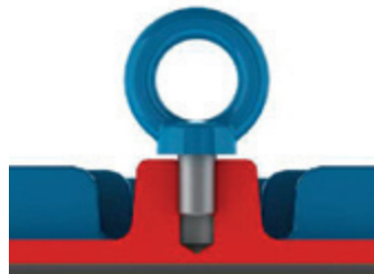
Рисунок 4.2 - Неправильное затягивание рым-болта
