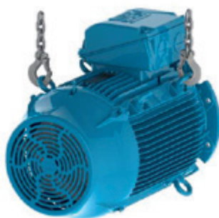
Figura 4.19 - Resultado final: motor posicionado na posição horizontal
