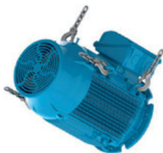
Рисунок 4.18 - Вращение двигателя в горизонтальное положение
