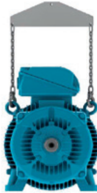
Figura 4.6 - Uso de barra separadora en la elevación
