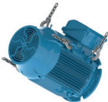
Фигура 4.18 - Двигателят се завърта в хоризонтално положение
