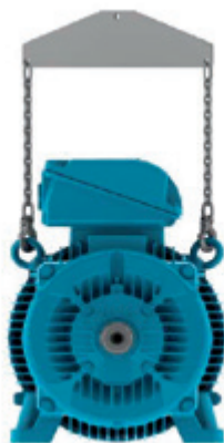
Рисунок 4.6 - Использование распорной траверсы при подъеме
