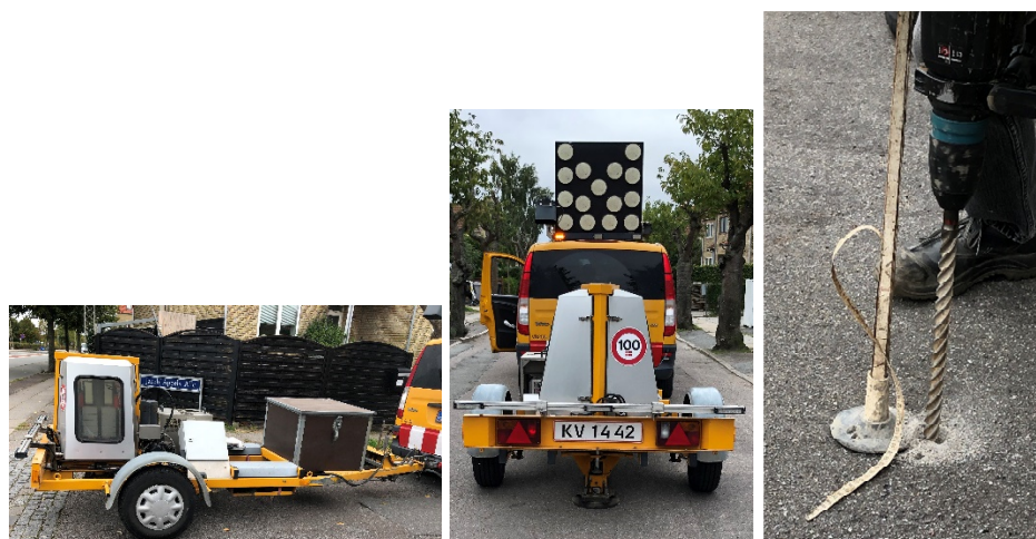
Figur 11 Til venstre: Bæreevnmåling (FWD) på strækningerne. Måling hver 50 m, og 1 måling på hver af stikvejene samt 1 måling på P-plads. Til højre: Boroskopmålinger. Der er udført 7 af disse. Hullerne lukkes med kold asfalt.
