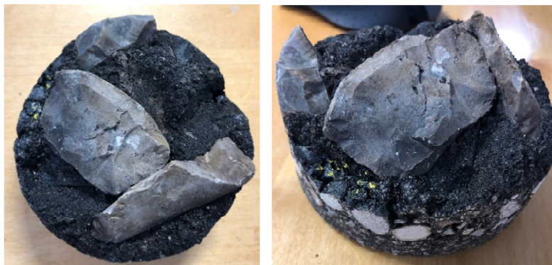
Figur 12 Borekerner med fastsiddende skæver.
