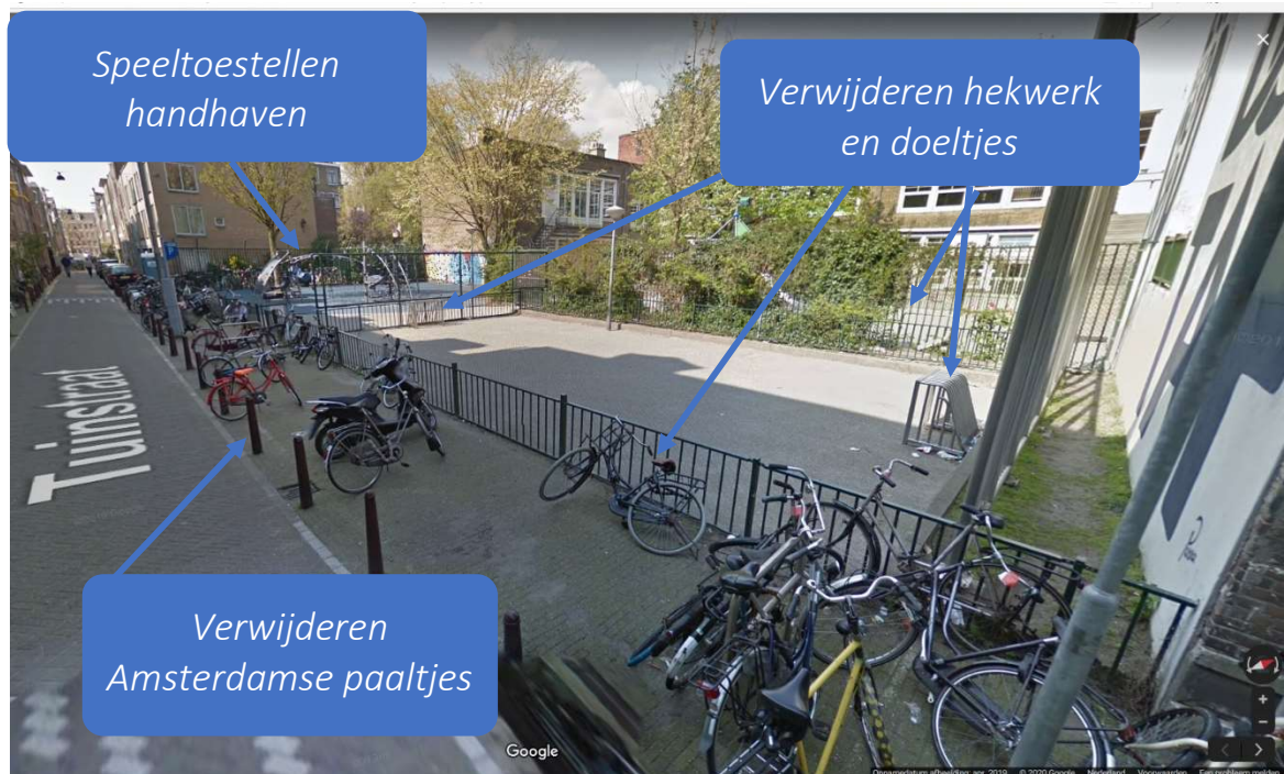
Tijdelijk verwijderen van Amsterdamse paaltjes, hekwerk pannakooi, hekwerk schoolplein en toestellen op het schoolplein i.v.m. tijdelijke (inrit)bouwplaats (bron: Google Maps)
