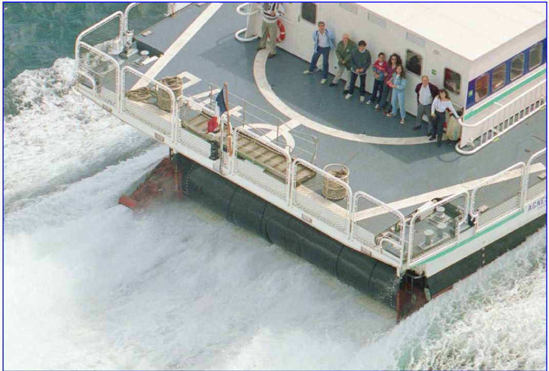
Figure 9.5: Stern and Rear Corners of Modern Skirts (d) Constructions Mecaniques de Normandie AGNES 200
