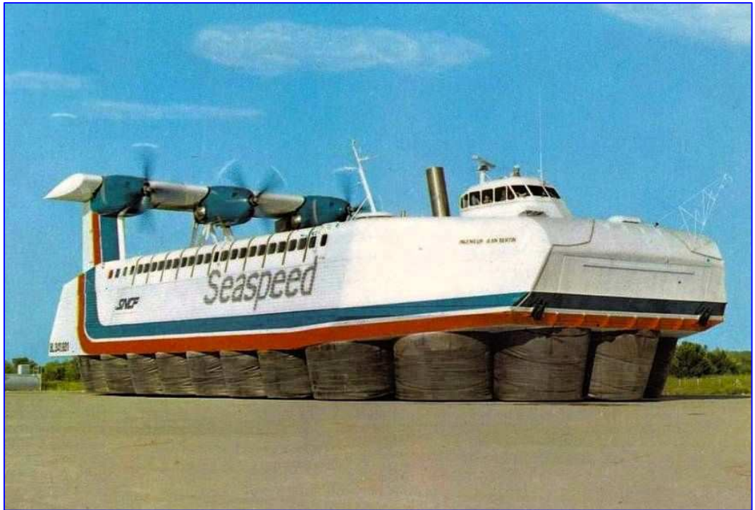
Figure 8.17: SEDAM N.300 and N.500 Naviplanes (d) N.500 with Original Jupes over Land Ingénieur Jean Bertin
