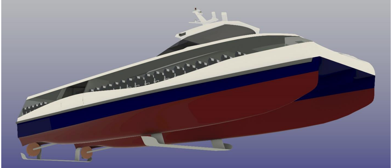
Figur 3-5: 3D-rendering av fartøyet med foiler (Sivilingeniør Ola Lilloe-Olsen)
