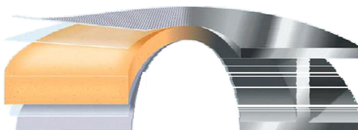
Figur 9 Prinsippet bak sandwich konstruksjoner (kilde: DIAB)
