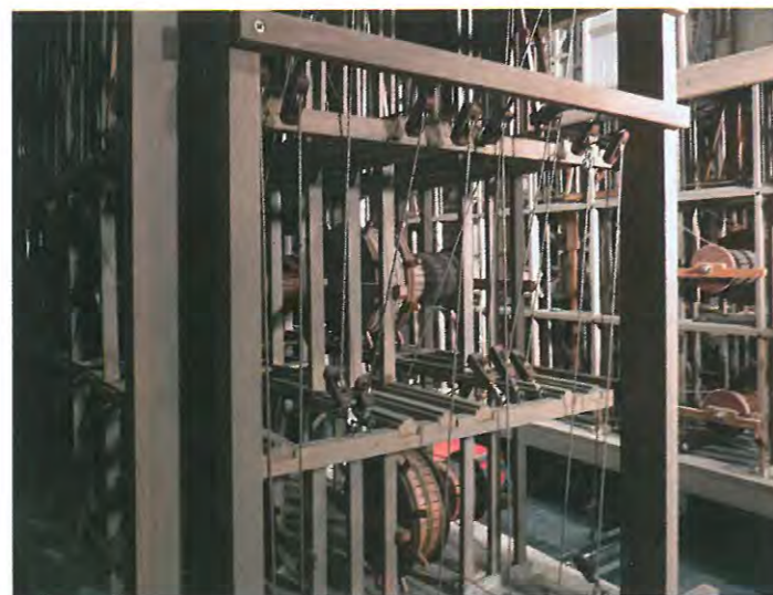
Voll funktionstüchtig: Die Unterbühnen-Maschinerie, maßstabsgetreu. Hier lassen sich Arbeitsvorgänge studieren und aktualisieren
