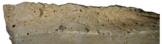
Fig. 5.5 Scherfkenmerken bij tegel A000/G45/M13, dikte 17,0/15,4 mm.
