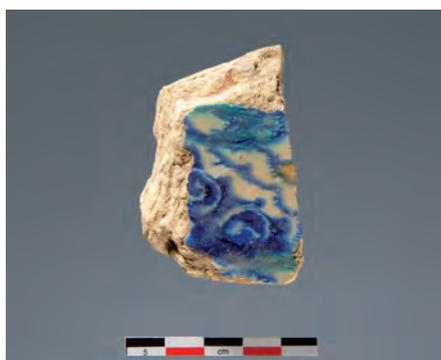
Fig. 22a - Deux carreaux avec glaçure qui a fondu sous une température trop haute, majolique d'Anvers, fouilles du château "La Fontaine". © MNHA, Inv. 2003-022-559-19/ 2003-022-362C.
