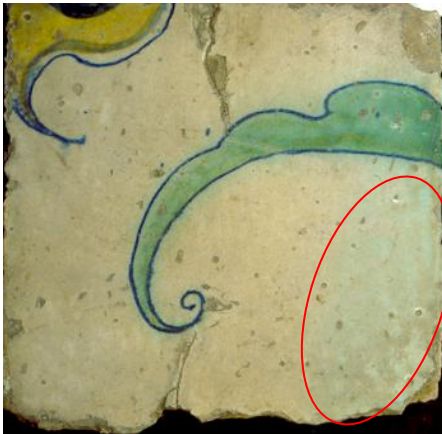
Uitstraling van groen glazuur op tegel C02080 (links) en gekookt glazuur op tegel A01040 (rechts) waardoor kratertjes ontstaan. Merk bij de linker tegel ook de gecorrigeerde trek op onderaan de gele zaadknop.
