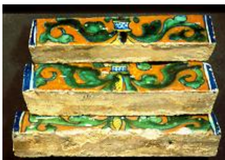
Engobe op de randen van tegel REP010, REP020 en REP030.
