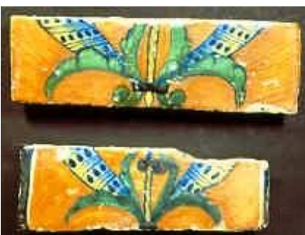
Te schraal aangebrachte oranjekeurig glazuur op de witte engobe onderlaag van tegel REP060 en REP070.
