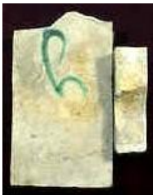
Glazuur op breukranden: tegel D0605+ en D07040.
