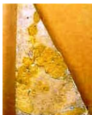
Glazuurplak van aanleunende tegel in de oven: C05010 en C03040.
