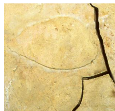
Glazuurplak van aanleunende tegel in de oven: C05010 en C03040.
