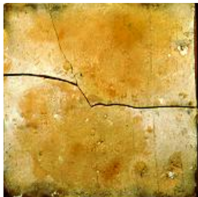
Verontreiniging van de scherfkern, zichtbaar op de rug, maar ook aan de afgesprongen puntjes glazuur aan de voorzijde: tegel A05030.
