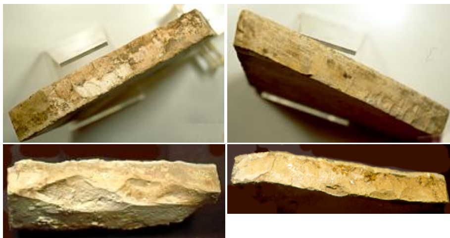
Voorbeelden van afgekalfde tegelranden: tegel A03010 aan de linker zoneboord, tegel A06060 aan de rechter zoneboord, tegel A02060 middenin de zone, tegel B03100 uiterst rechts in de aanliggende zone.
