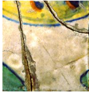
B02100: afgesneden X-inkerving aan de linkerboord van de tegel, C06050: X-inkerving onder het glazuur in de hoek rechtsonder.
