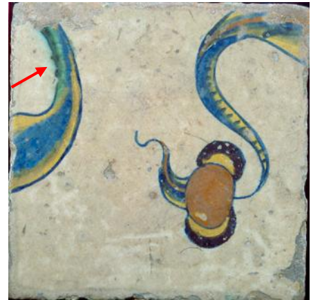
Uitstraling van groen glazuur op tegel C02080 (links) en gekookt glazuur op tegel A01040 (rechts) waardoor kratertjes ontstaan. Merk bij de linker tegel ook de gecorrigeerde trek op onderaan de gele zaadknop.
