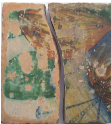
Twee helften van eenzelfde tegel, rechts vóór reiniging, links na behandeling met de Steamup.
