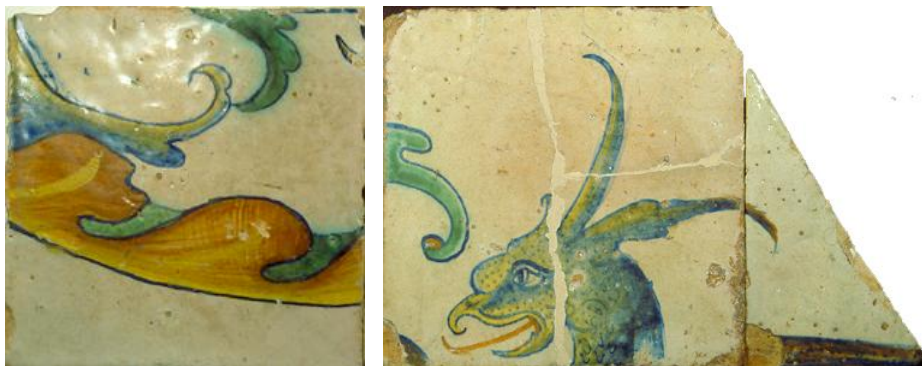
Tegels B01110 (links) en B06060 (rechts) waar de rode scherf doorheen het witte tinglazuur schijnt.
