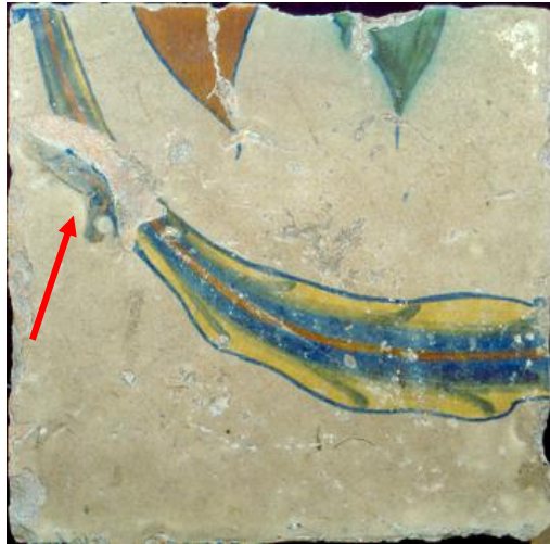
Tegel A01070 met glazuurschade opgelopen tijdens het gladbranden.
