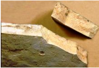
Gele en roze gelaagdheid van de scherfkleur op de breukrand: tegel B0106+.
