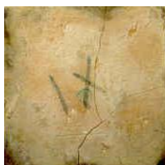
Glazuurvlek op tegelrug A04030 en F05070.
