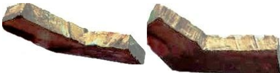
Glazuur op afgestoken randen van tegels N04020 en N04030.
