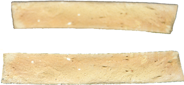
Verontreiniging binnenin de scherfkern: twee helften van tegel A03070.
