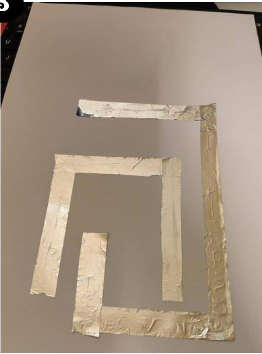
Couper les bandes pour qu'elles recouvrent précisément le circuit et les coller avec une colle en stick.
