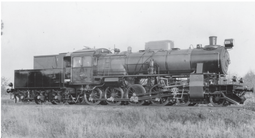
Ett malmtågloks (Nohab 1931, litt. Mb, från 1932 G12, från 1945 SJ E9 1757, skrotat 1975). Typen har bedömts vara en av Sveriges bästa ånglokskonstruktioner. Sex lok tillverkades för HNJ och klarade av malmtrafiken.
