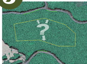
1 | Avgränsa objektet. En GIS-modell visar bra avläggsplatser (ljusgrönt) som tillsammans med objektdata ger dig förslag på effektiva och skonsamma basvägar i Nya Bestway.
