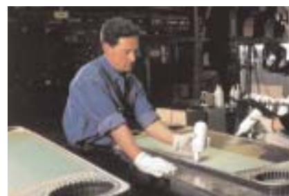
6. Ompackning. Originalreservdelar väljs för att garantera optimal tätningseffekt, maximal nettodrifttid och minskade driftkostnader. Alfa Laval hjälper dig att hitta den rätta packningen till din plattvärmeväxlare med utgångspunkt i typ av medium, tryck och temperatur.
