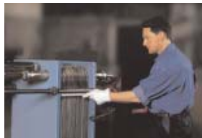
8. Provtryckning. Som tillval kan Alfa Laval kontrollera med provtryckning att packningarna åter är täta i hela plattvärmväxlaren.
