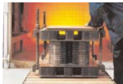
7. Ugnshärdning. Fastvulkning av originalpackningarna vid plattorna med Alfa Laval's unika extrastarka epoxylim.
