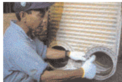
5. Kontroll av plattorna. Alfa Lavals serviceingenjörer företar ytterligare en noggrann granskning av plattorna för att upptäcka eventuella deformationer som inte var synliga när packningarna satt på plats.
