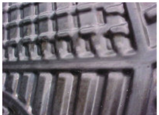
Deformation av det diagonala packningsspåret.
