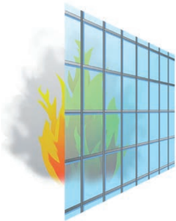
Brand från insida. Utfackningsvägg max höjd 3000 mm.
