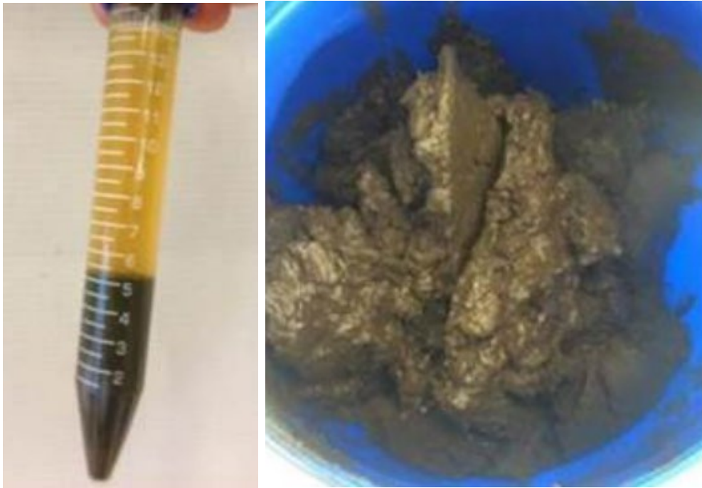
Figur 16. Brun saft (venstre) og fiberfraktion efter skruepresse (højre) (Jensen et al., 2015)
