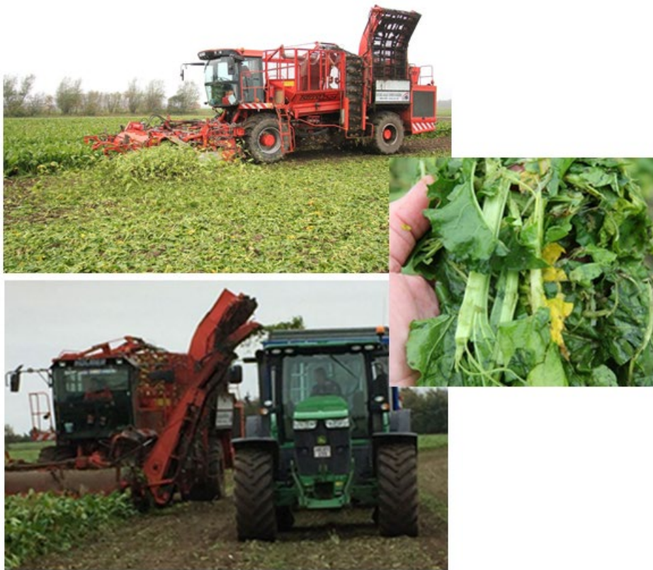
Figur 15. Høstning af roetoppe. Konventionel metode, der efterlader roetoppe på marken (øverst) og opsamling af roetoppe (nederst) (Larsen et al. 2017)
