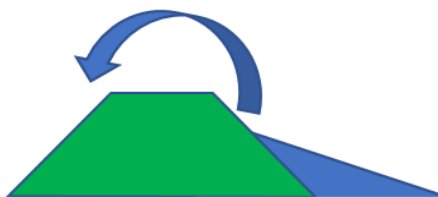
Figuur: Golfoverslag en erosie voorkomen door golfoploop te breken met buitenwaartse dijkbekleding en vooroeverbesteding, in combinatie met voldoende kruinhoogte. (Buitenwaartse stabiliteit)
