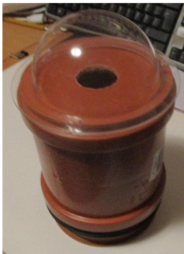
Markavloppsrör 100 mm med proppar och kupol.
