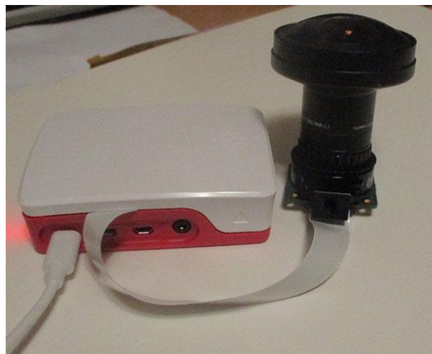
Raspberry Pi 4 med HQ kamera och fisheye.
