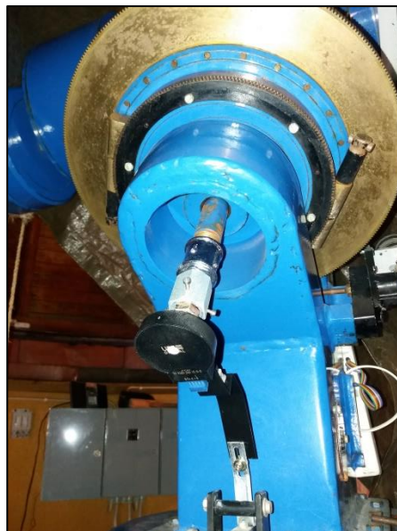
Lägesgivare (enkoder) monteras på axlarna för RA och Dec. Här visas den svarta givaren på RA-axeln.
